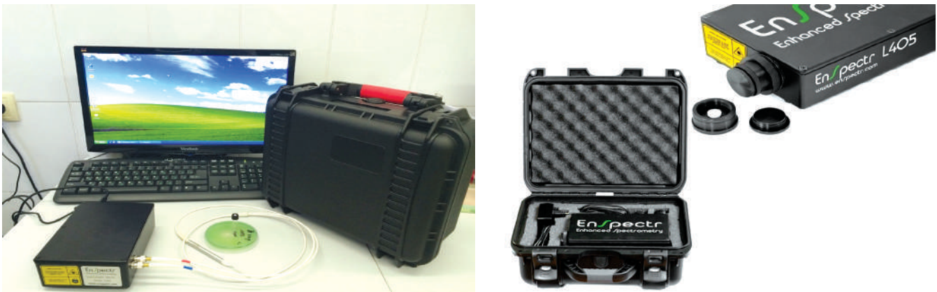
Рис. 2. Модификации прибора «ИнСпектр М» с оптическим волокном и насадками для работы с биологическими жидкостями, мазками и биопсийным материалом.
