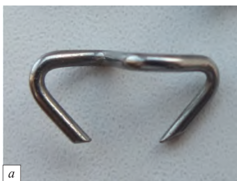
Рис. 3. Скобки из никелида титана с памятью формы.
