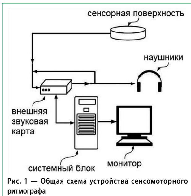
с задаваемым режимом, внешней звуковой карты и персонального компьютера с соответствующим программным обеспечением, включающим программный метроном (рис. 1).
