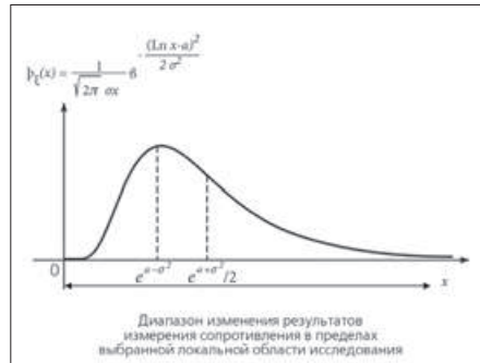
Рис. 13. График теоретического логнормального распределения вероятностей результатов измерений сопротивления в пределах исследуемых локальных областей шлифа “реставрация – ТТЗ”
