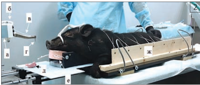
■Рис. 2. Мини-пиг 1. Протокол исследования №5. Этап позиционирования экспериментального поля работы РАС: а — кронштейн-фиксатор наконечника физиодispensера; б — узел регулировки угла наклона рабочего инструмента; в — наконечник микромотора физиодispensера; г — костная фреза; д — индивидуальная капа; е — подбородочный упор; ж — авторский операционный стол
