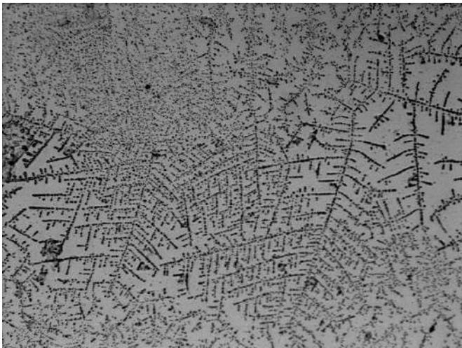
Рис. 8. Кристалл с разрывом структуры CGS.
