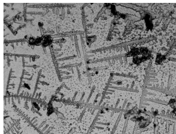
Рис. 4. Отсутствие вершины кристалла (отросток 1-го поколения отходит от вершины кристалла) CWT. ASS – есть.
